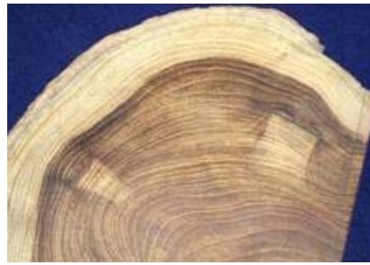
(i) आग के कारण तथा (ii) कीट आक्रमण के कारण घावों के साथ सागौन डिस्क
