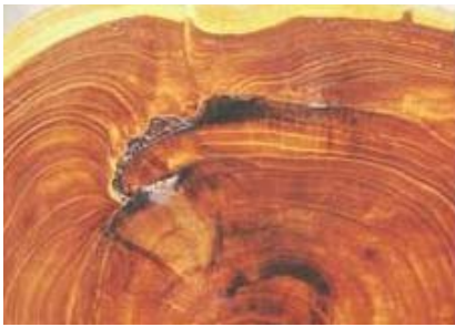
(i) आग के कारण तथा (ii) कीट आक्रमण के कारण घावों के साथ सागौन डिस्क
