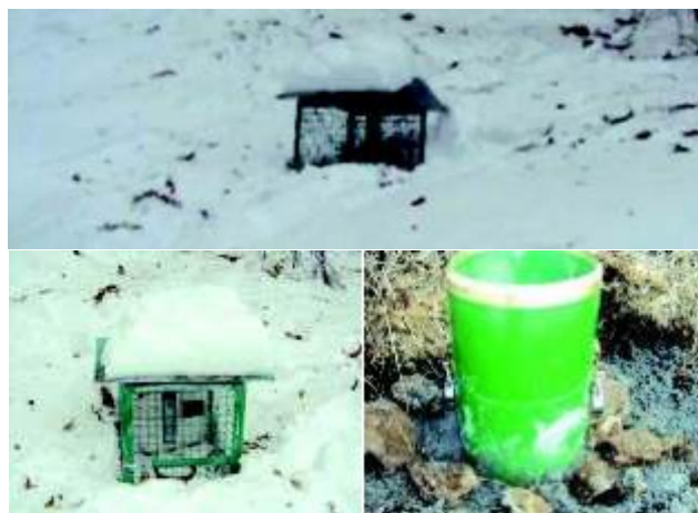
निम्नतम-अधिकतम तापमान, नमी, वर्षा तथा सोलर विकिरण के लिए मौसमीय आंकड़ें एकत्रित किये गये
